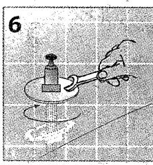
**6** Sfilare il sedile e bloccare definitivamente i piantoni con una chiave, mantenendo la rondella cromata allineata al segno tracciato precedentemente a matita. Per un corretto bloccaggio dei 2 piantoni effettuare 2 giri completi con la chiave.
