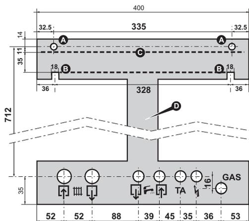
**Nota:** È disponibile separatamente l'apposita dima riutilizzabile in metallo (**D** in figura) che agevola il posizionamento degli attacchi (utilizzando il Kit Raccordi originale) e dei punti di fissaggio direttamente in opera. **Se non si utilizzano la dima in metallo e/o il Kit Raccordi originale, vedere la posizione degli attacchi idraulici della caldaia nel paragrafo "Dimensioni e attacchi" a pagina 13.**
